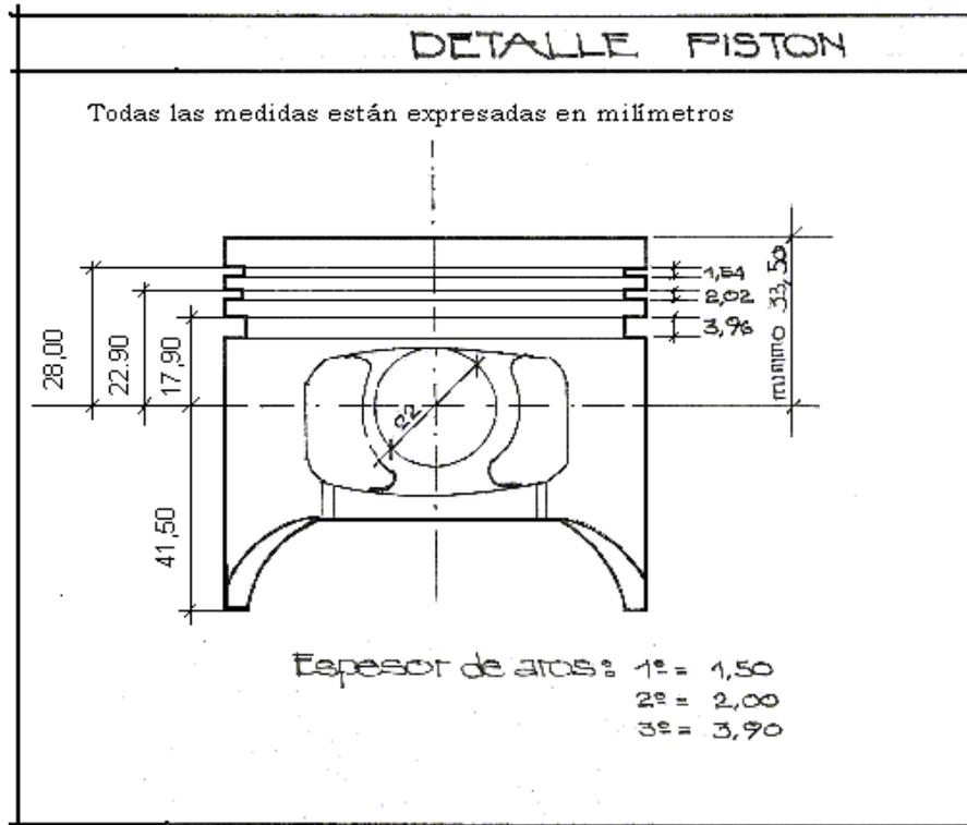
**f. Pernos de Pistón:** Libres, conservando el diámetro original, su fijación es flotante en biela y pistón. Se permite cortar el perno para colocar el seguro "seger". Seguros: libres.
