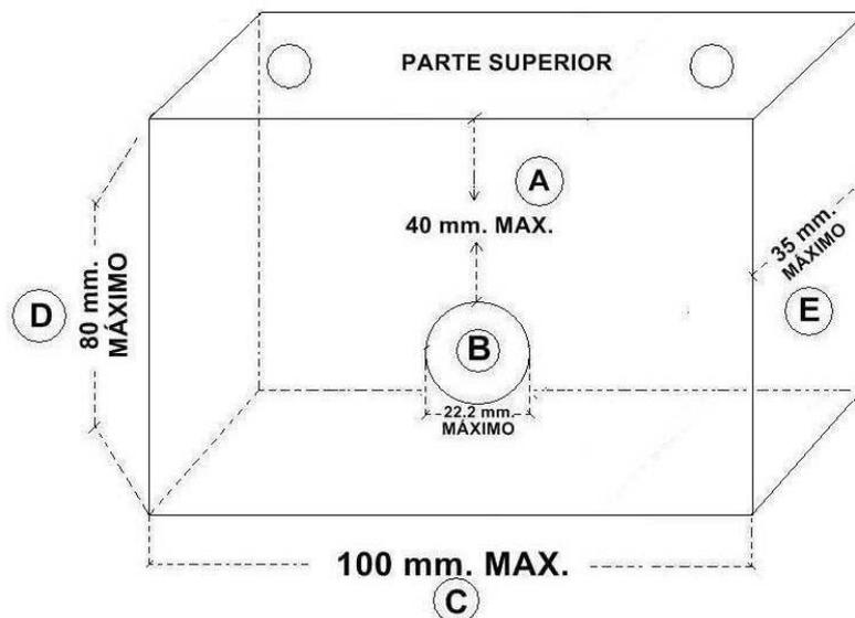
Para los que pongan buje de barra original, pueden llegar a la altura de los 40 mm. (COTA A) Suplementando el porta buje entre el apoyo del chasis y el mismo buje
